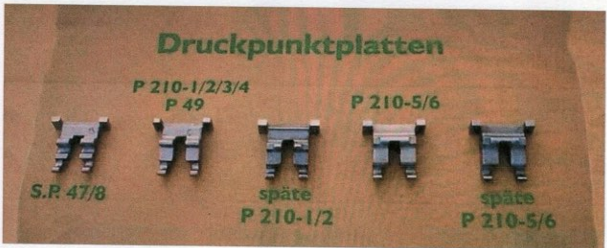
▲ I differenti punti di pressione utilizzati nei pacchetti di scatto delle varie versioni di Sig rinvenuti in una bibliografia dedicata (a sinistra quello della Sp 47/8)
