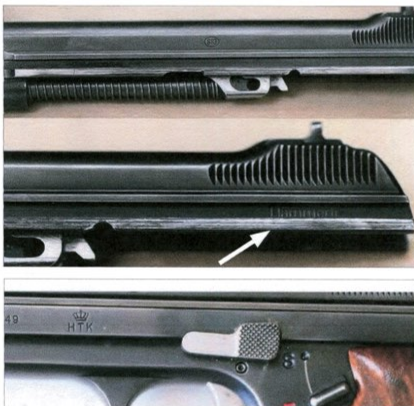
La stampigliatura: 9 mm P m49 e la "HTK" sotto la corona reale sul lato sinistro del fusto ▲
