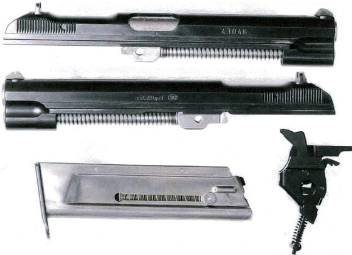
▲ Lati sinistro e destro del carrello delle conversioni in calibro .22 Lr degli anni Cinquanta, brunitura lucida e caricatore in bianco e cane più basso pvfrevisto principalmente per i carrelli dotati di tacca di mira regolabile
